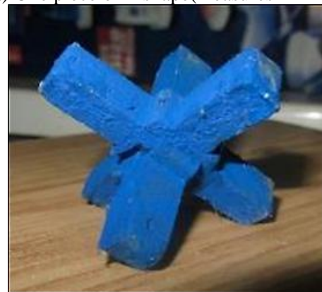
b) precast SLC elements
